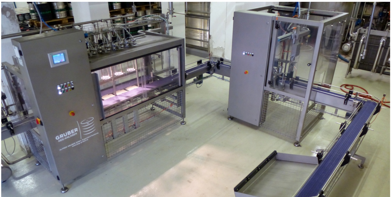
AFD 6 mit automatischem 5l Dosenverschleißer AFD 6 with a fully automatic 5l partykeg capper
